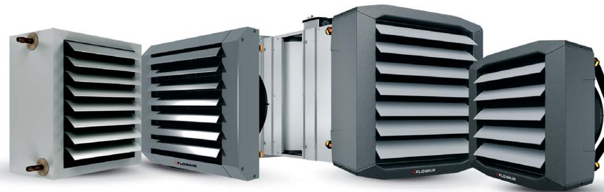
Fot. 4. Nagrzewnice wodne LEO mogą współpracować z dowolnymi źródłami ciepła, jedynym ograniczeniem jest maks. temperatura czynnika grzewczego, która w zależności od modelu urządzenia może sięgać nawet 130°C.
