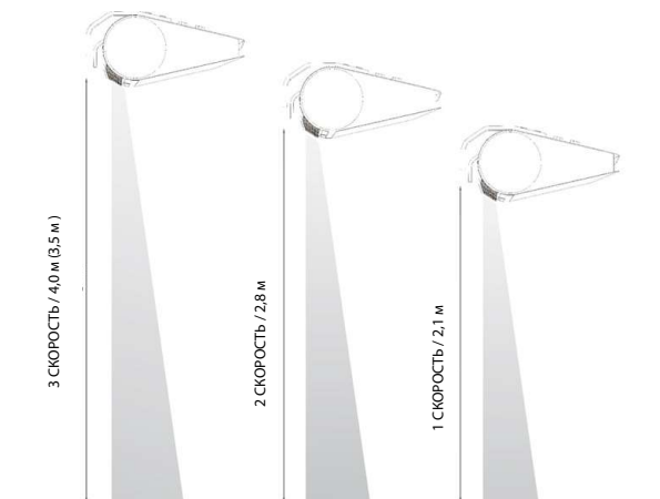
РИС. 2.2 ДЛИНА ПОТОКА ВОЗДУХА НА КАЖДОЙ СКОРОСТИ.
