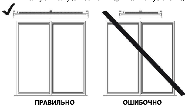
РИС. 7.1 ПРАВИЛЬНАЯ ГОРИЗОНТАЛЬНАЯ УСТАНОВКА.
